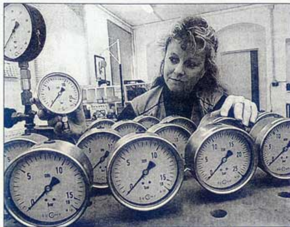
Zwischen 8000 und 10.000 hochwertiger Druckmessgeräte werden bei der Firma Suchy Messtechnik in Garnsdorf jährlich produziert. Hier: Birgit Suchy bei der Kontrolle von Edelstahl-Manometern. —FOTO: ANDREAS SEIDEL
